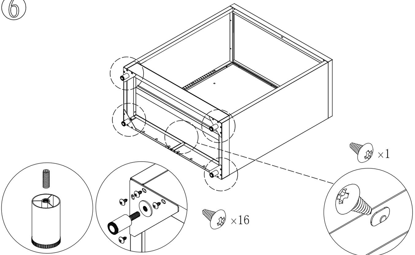
Befestigen Sie die Bodenplatte mit 1 Schraube in Position
