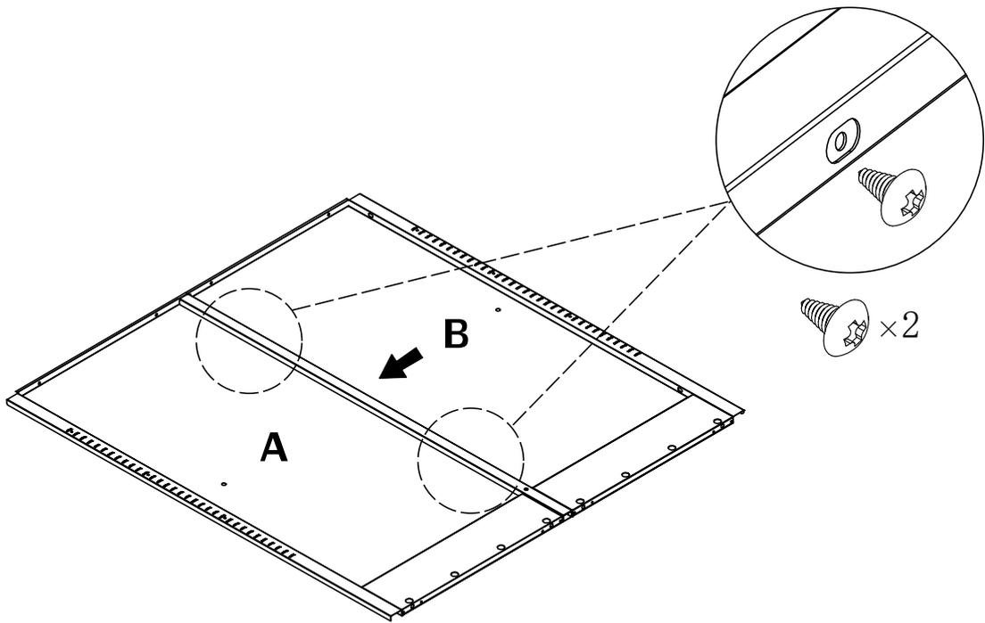
Überlappen Sie den Rahmen von Paneel B mit dem Rahmen von Paneel A
