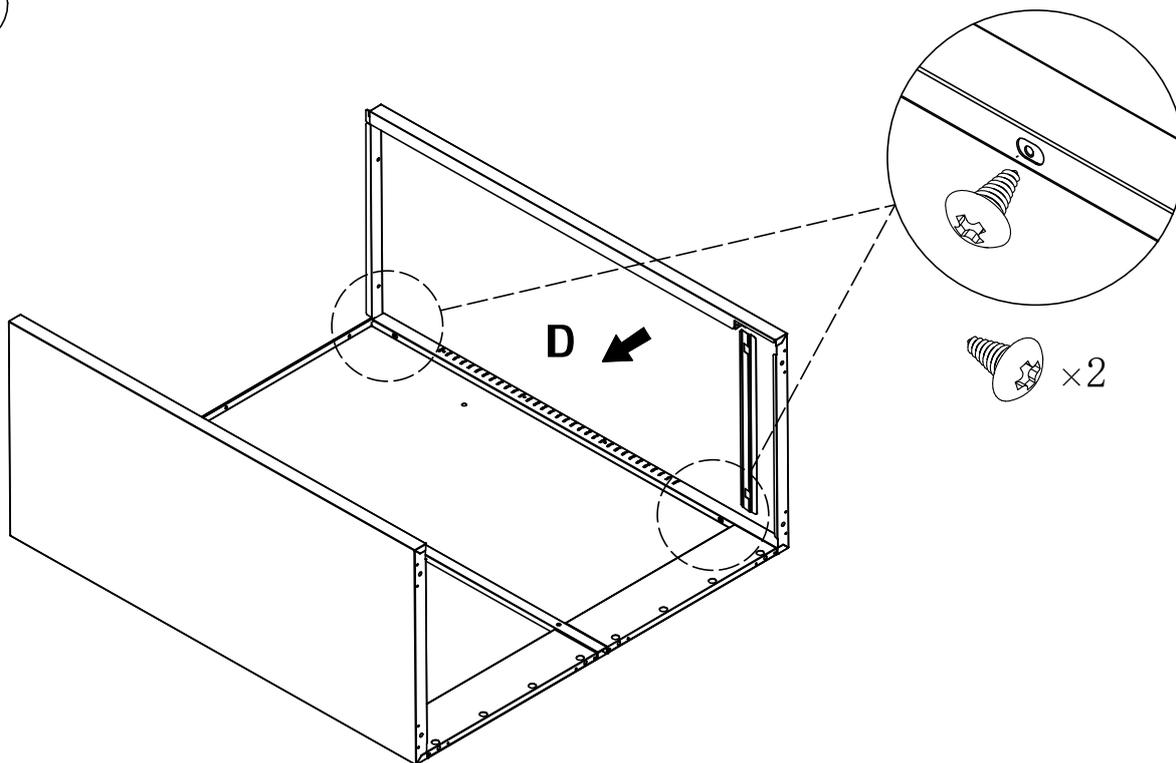
Überlappen Sie den Rahmen von Platte B mit dem Rahmen von Platte D
