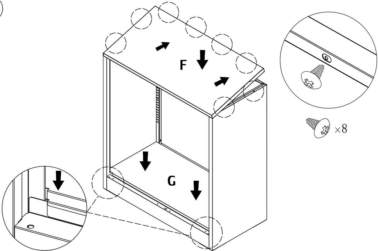
Installieren Sie die obere Platte und die untere Platte
