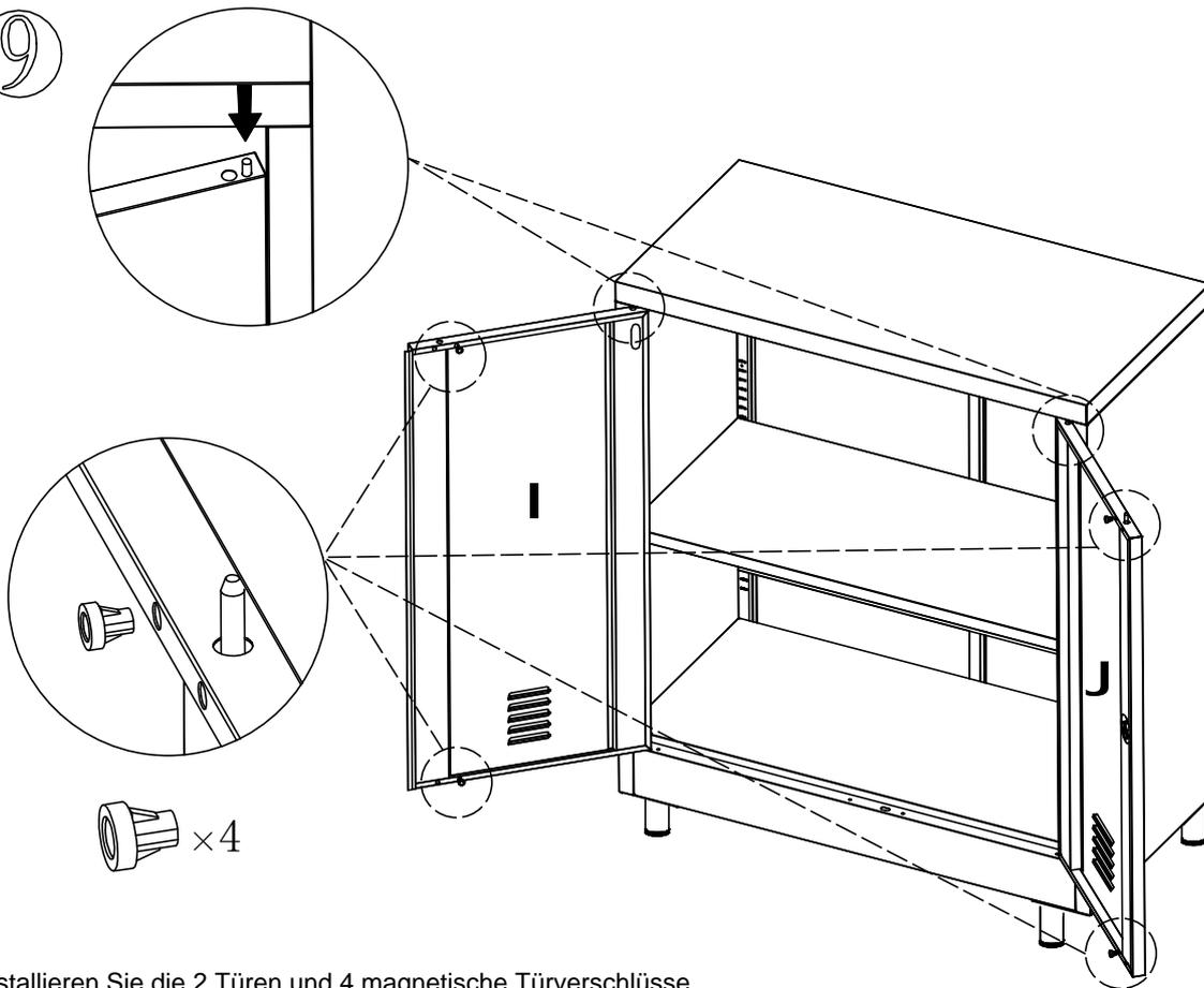
Installieren Sie die 2 Türen und 4 magnetische Türverschlüsse
