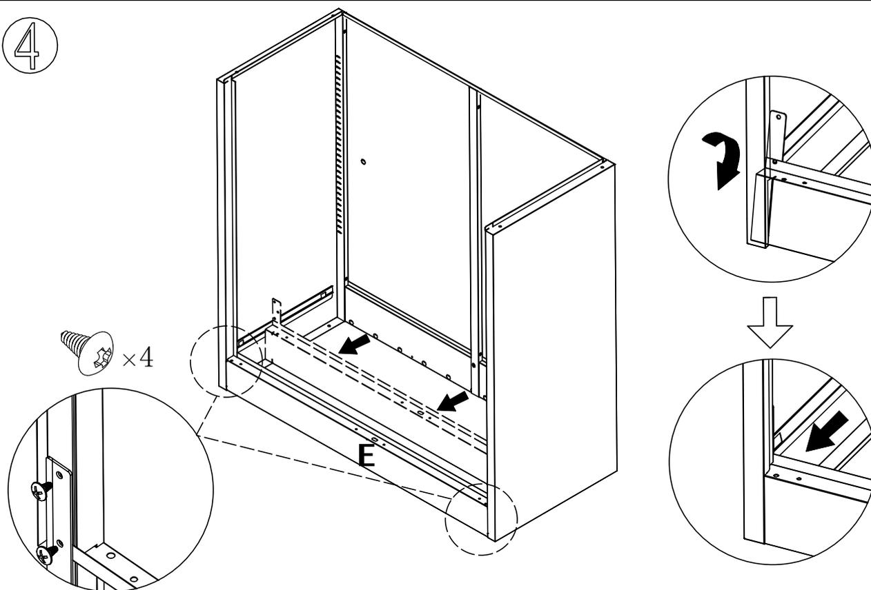
Installieren Sie den unteren Balken mit Schrauben
