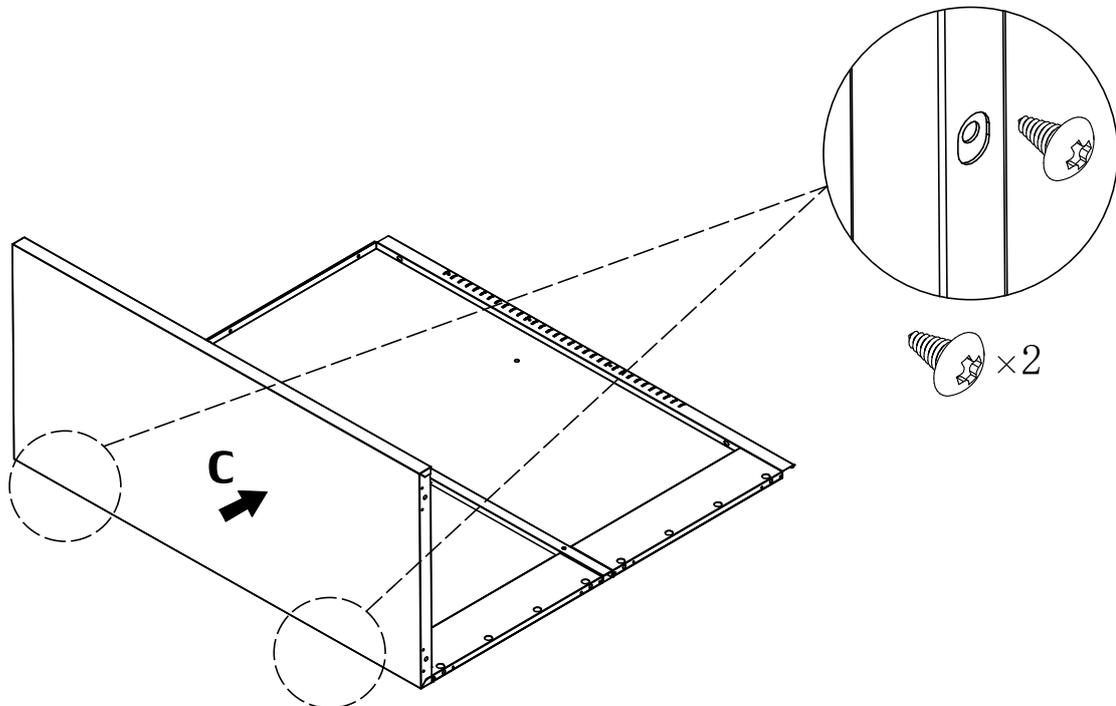
Überlappen Sie den Rahmen von Paneel A mit dem Rahmen von Paneel C
